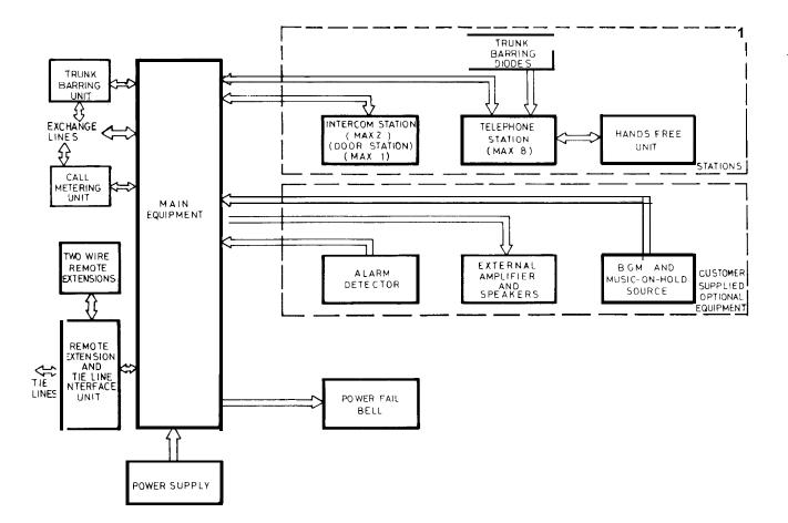
FIG. 6 - N308 SYSTEM BLOCK DIAGRAM
